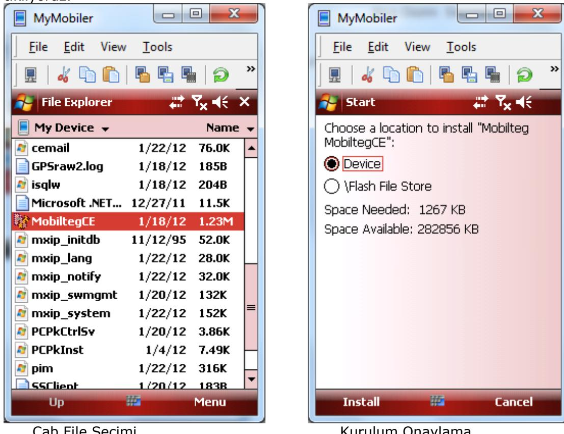
Install Seçeneğine bastığımızda Kurulumu Cihaz içinde Bulunan Program Files\MobiltegCE\ Klasorune yapacaktır.
