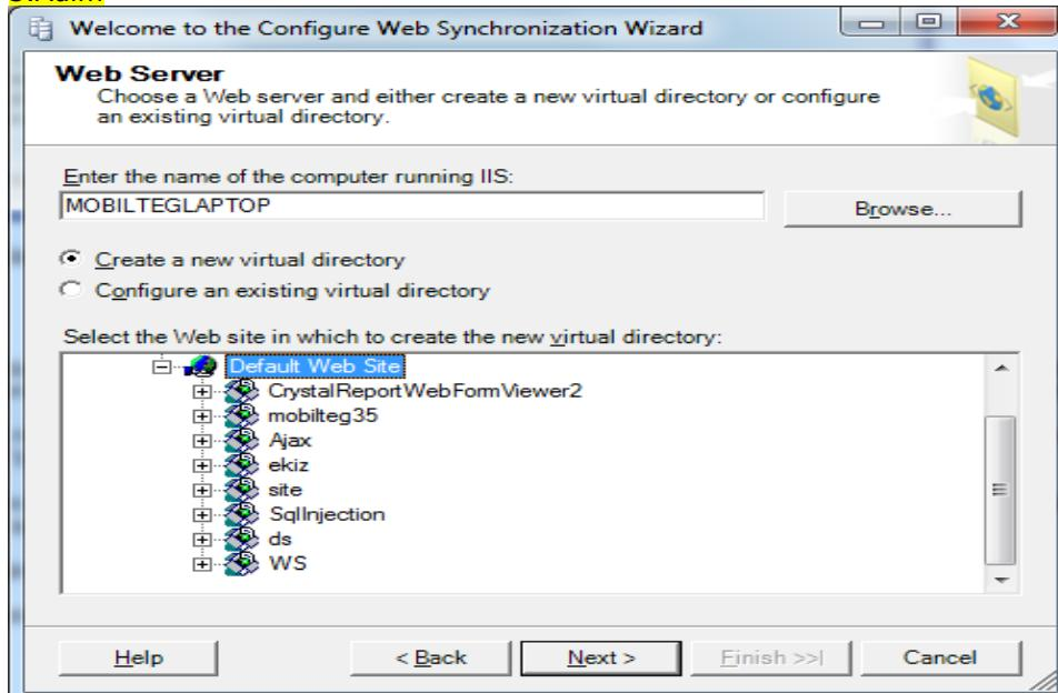
Bu ekranda bulunan "Enter the name of the computer running IIS" yazısı altında bulunan alana IIS'in üzerinde çalıştığı pc adı girilmelidir. Otomatik olarak kurulum yapılan pc adı gelecektir.
